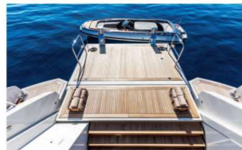
LANDINGSPLASSEN: Gjester som kommer med båt blir satt ombord via den nedfelte hekken.
