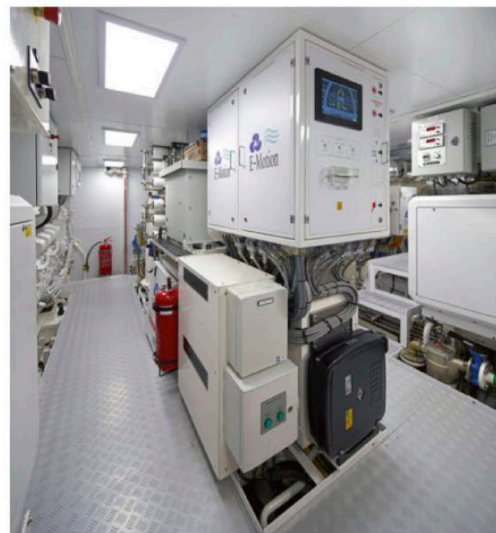
Les moteurs principaux (2 x 1200 ch) sont couplés à des générateurs de 300 kW, pour une vitesse maximale de 18 nœuds.
